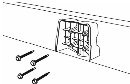
Gebruik de meegeleverde 4 x teksschroeven om de beugel op een plat oppervlak of een ronde houten paal te monteren.
