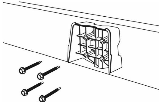
Per il montaggio su una superficie piana verticale o su un palo in legno rotondo utilizzare le 4 viti TEK incluse nell'unità.
