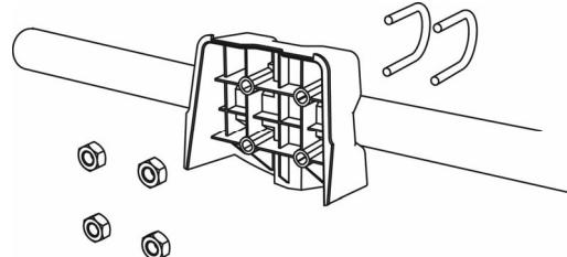
Die Waagenhalterung keinesfalls auf dem Verschlag oder dem Wiegekäfig montieren.
