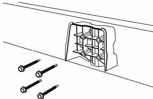
Pour monter le support sur une surface plane et verticale ou sur un poteau cylindrique, utiliser les 4 vis autoperceuses fournies avec l'appareil.
