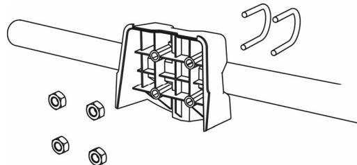
Ne pas installer le support de l'indicateur de pesée sur le conteneur de pesage.
