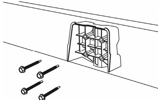
För att montera fästet på en plan, vertikal yta, eller en rund trästolpe, använd de 4 självborrande skruvarna som medföljer enheten.
