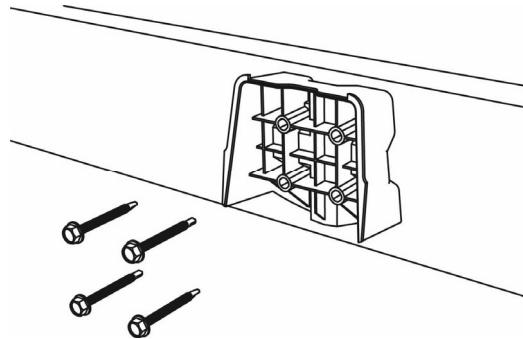
Para montar el soporte sobre una superficie vertical, un poste redondo de madera o un raíl, utilice los 4 tornillos Tek incluidos con la unidad.
